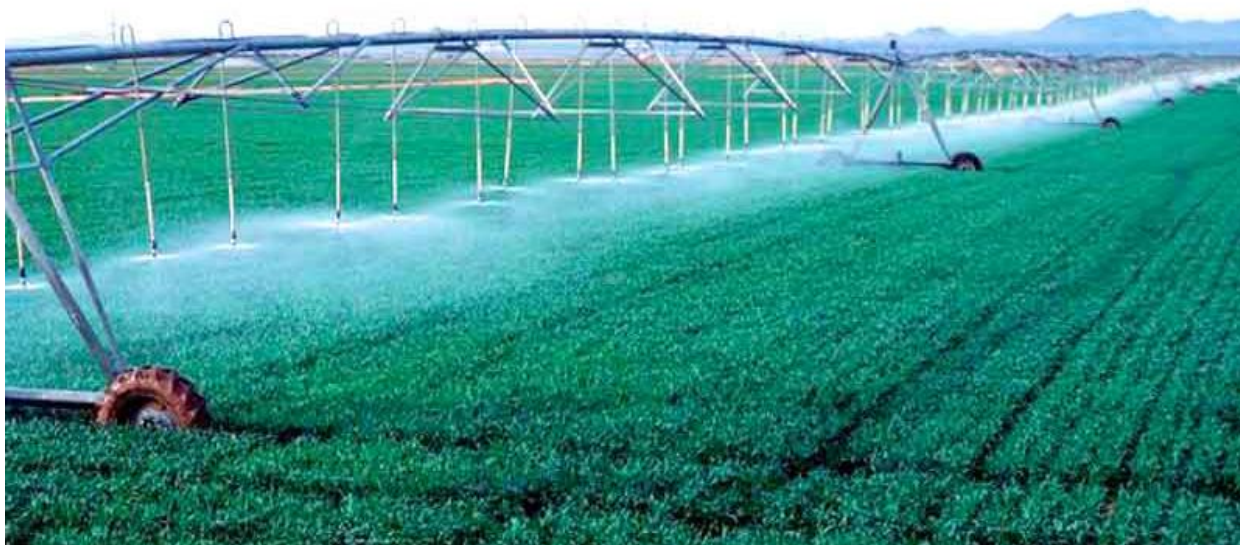
Рис. 10. Полив дождевальной машиной ДФ-120 «Днепр»
