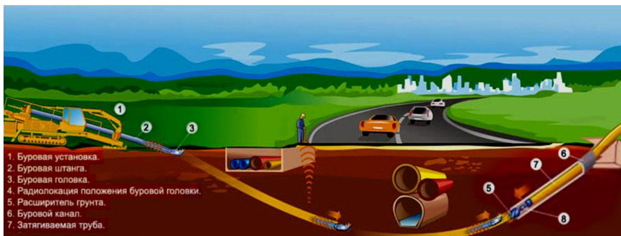
Рис. 37. Схема прокладки подземных коммуникаций (бестраншейная прокладка)
