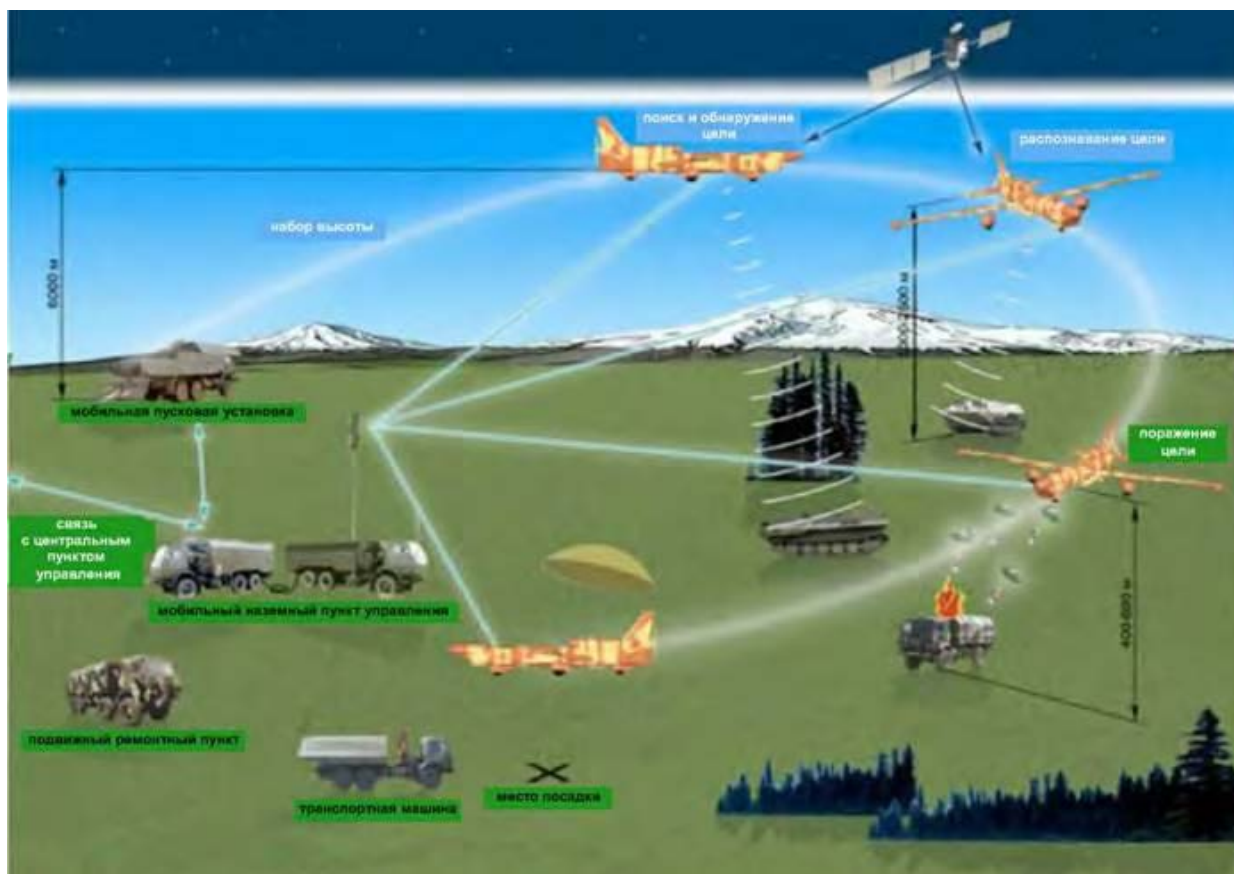
Рис. 212. Взаимодействие различных элементов БАС
